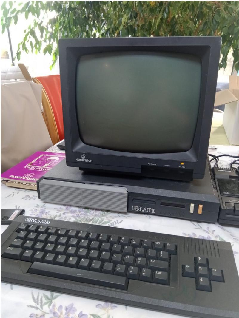
Petite particularité, le clavier est sans fil, avec un système infrarouge, avec une portée assez incroyable (à plus de 3m, ça fonctionne encore !) <https://t.co/H27Z39ITVA>
